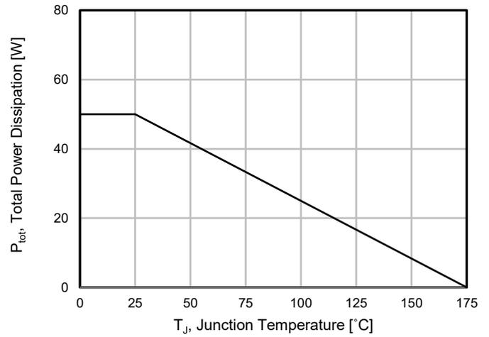
**Fig. 14. Power Dissipation**
